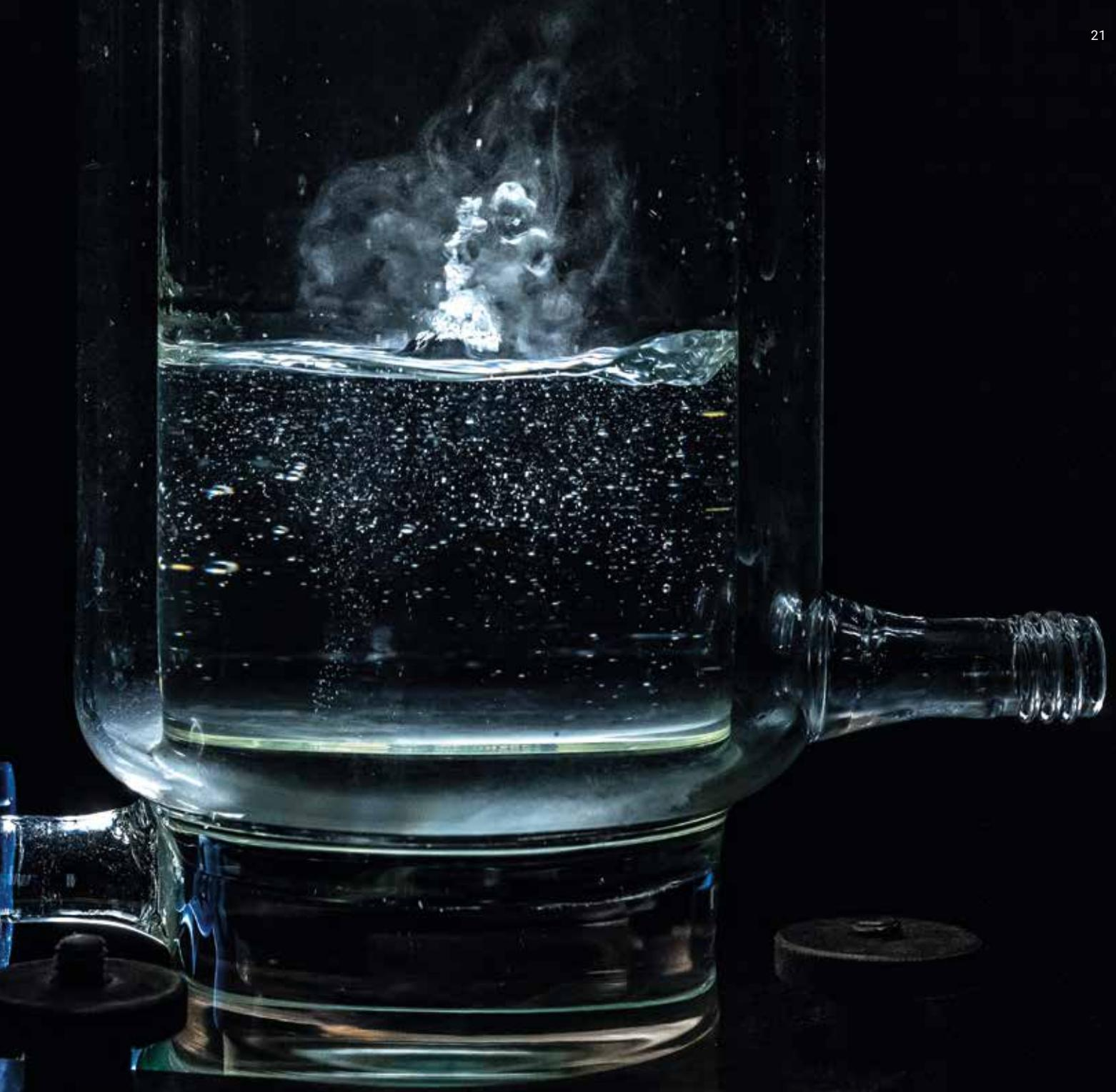
Die zur kalten Verbrennung benötigten Hydroxyl-Radikale lassen sich auch durch Einleiten von Ozon in das Abwasser erzeugen. Dieses aus Luftsauerstoff entstehende Gas wird dabei mit Druck im Abwasser fein verteilt. Neben den Hydroxyl-Radikalen trägt auch das Ozon selbst zur Oxidation von Schadstoffen und zum Abtöten biologischer Keime bei.
