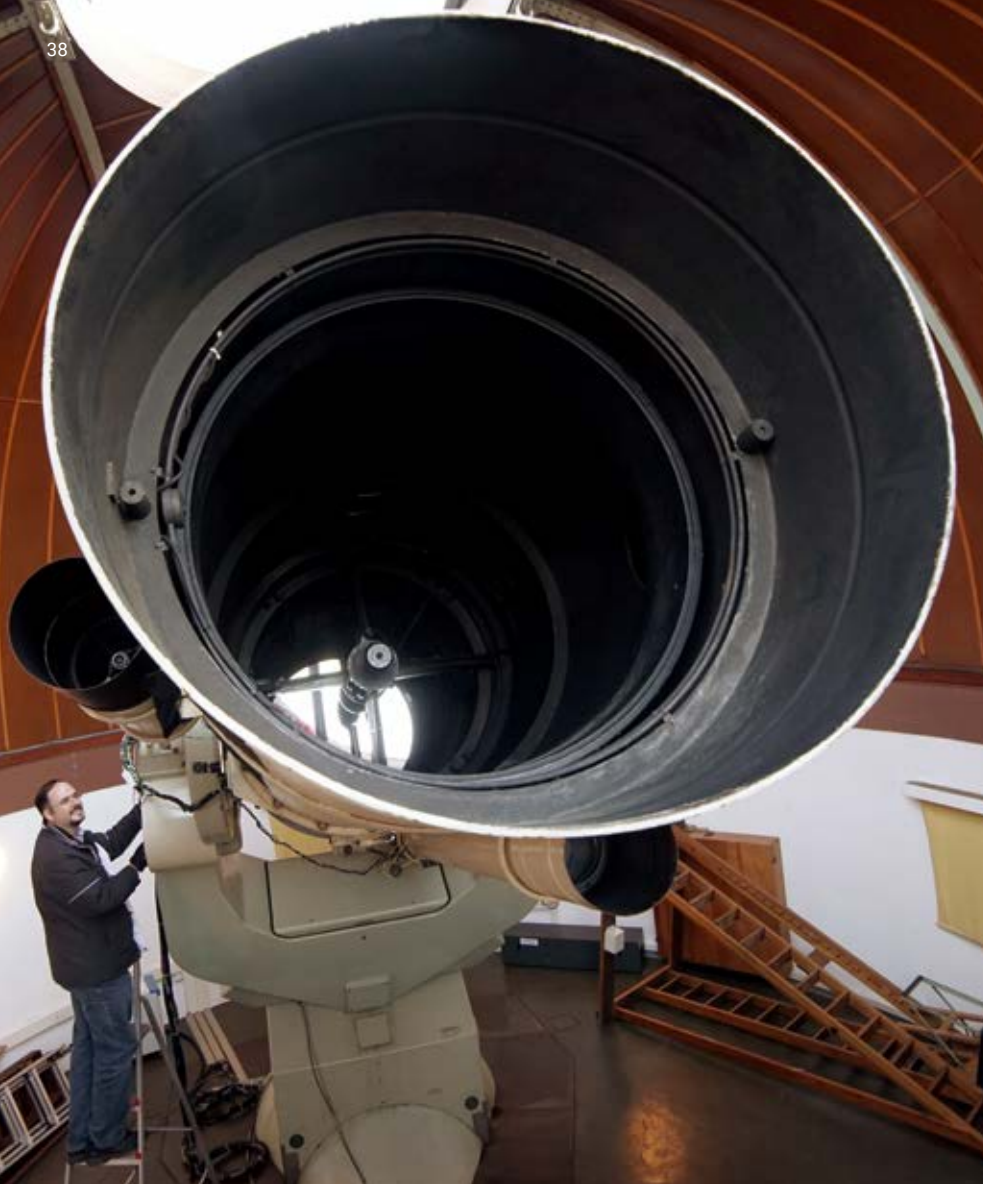
Letzte Handgriffe vor dem Start der Beobachtung: Dr. Markus Mugrauer prüft das kleine Cassegrain-Teleskop, das seitlich neben dem großen 90-Zentimeter-Spiegel montiert ist. Rechts unten ist zudem das Linsenfernrohr (Refraktor) zu sehen.
