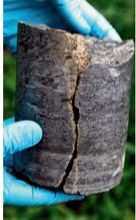
Foto oben: Bohrkernprobe einer Schillkalkbank (Oberer Muschelkalk). Die durch Verkarstung erweiterten Klüfte stellen Fließpfade des Grundwassers dar.
