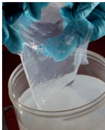
In Wundauflagen aus Nanocellulose wollen die Forscher entzündungshemmende Wirkstoffe verpacken, um chronische Wunden effektiver behandeln zu können.
