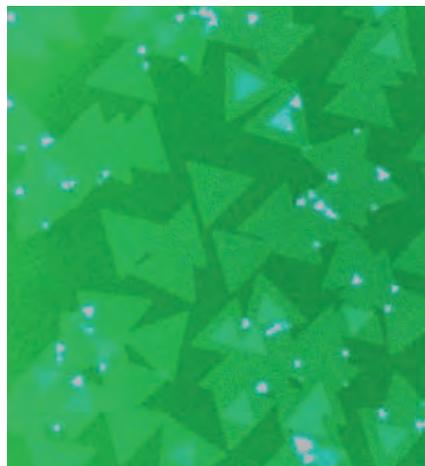
Perfekte gleichseitige Dreiecke: Die 2D-Kristalle aus Wolframdisulfid sind weniger als ein Nanometer dünn. Jede Dreiecksseite ist rund 30 Mikrometer lang.
