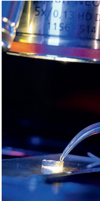
Probe einer metallorganischen Gerüstverbindung (MOF) in Glasform. Solche Bauteile eignen sich als Ausgangsmaterial für Filtermembranen, die Kohlenstoffdioxid und andere gefährliche Gase während Produktionsprozessen herausfiltern. · Foto: Jens Meyer
